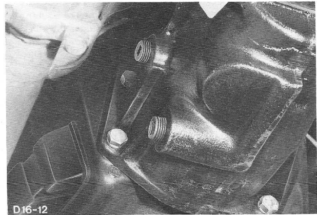
Fig.23 Versnellingsbak van koppelinghuis losmaken.
