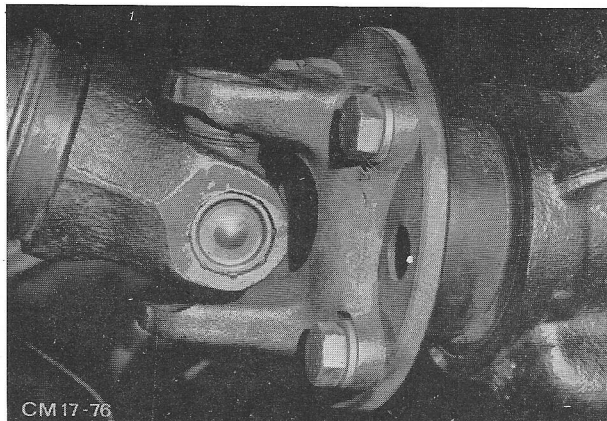
Fig.25 Cardanas van pignonflens losmaken.
