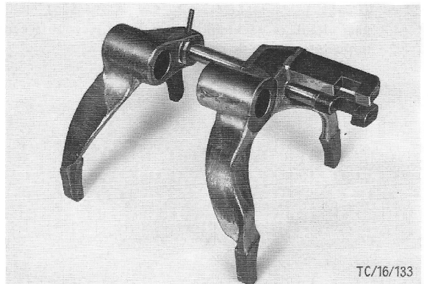
Fig.80 Schakelvorken voor 1e/2e en 3e/4e versnelling in elkaar zetten.
