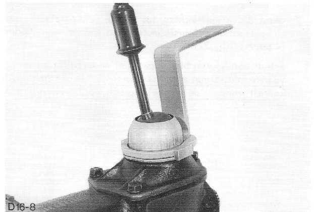
Fig.19 Versnellingshandel van versnellingsbak verwijderren met Speciaal Gereedschap 16-013.
