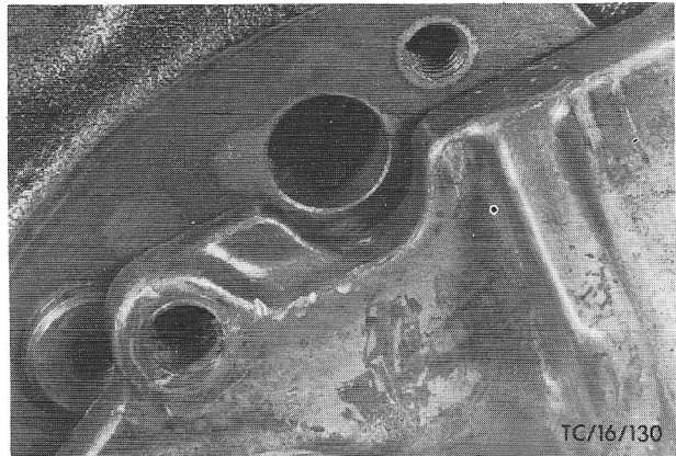
Fig.76 Boring voor secundaire as.
